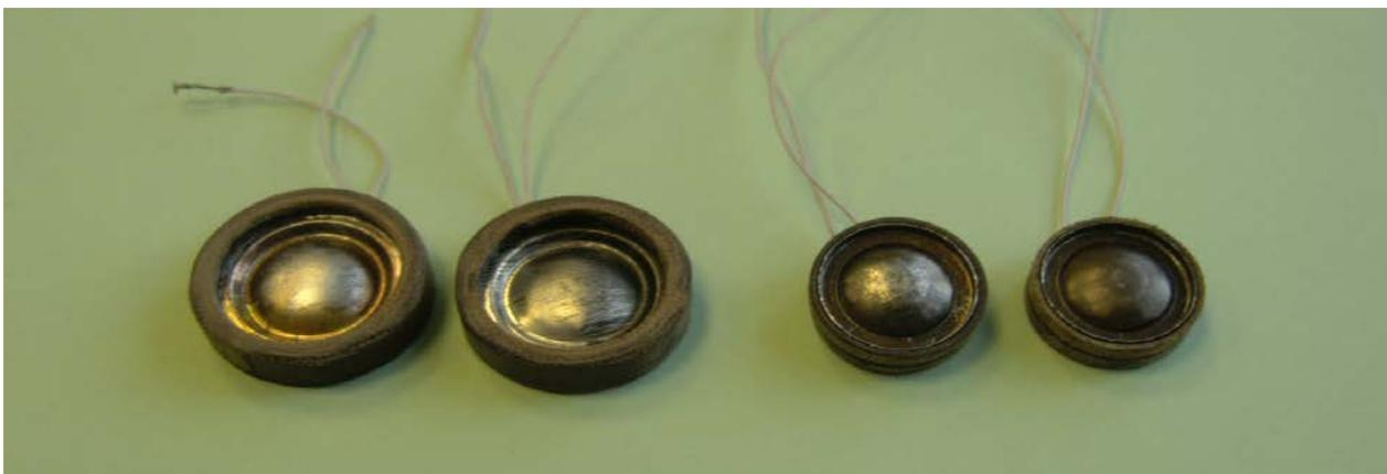
**Рис. 4. Опытные образцы ультразвуковых преобразователей с плоско-сферической диафрагмой. Слева – частотное исполнение 20кГц, справа – частотное исполнение – 40кГц.**
