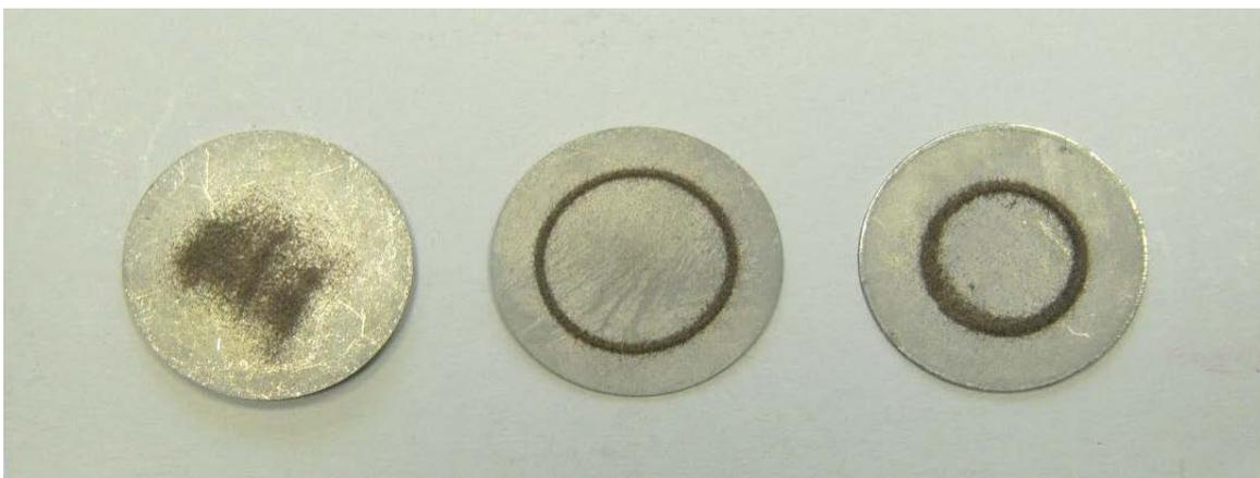
***Рис.2. Изображения узловых окружностей биморфного пьезоэлемента. Слева направо: исходное состояние, ненагруженный пьезоэлемент, пьезоэлемент с прикрепленной в центре массой на оборотной стороне.***
