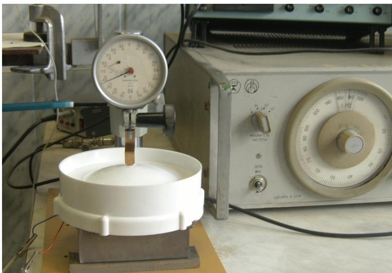
Рис.1 – установка для измерения амплитуды звуковых колебаний
